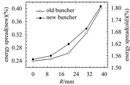
图 3 聚束器杂散电场对束流能散的影响,  $R$  为束流进入聚束器的横向位置.
