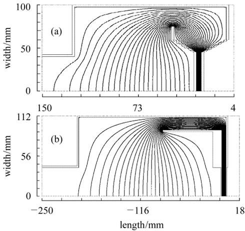
图 1 0B02 聚束器目前的(a)及新的(b)电极结构及电势分布
