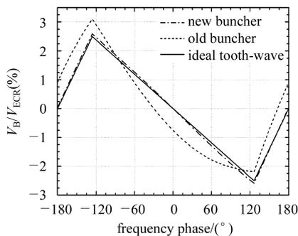
图 2 聚束器杂散电场对电压波形的影响
