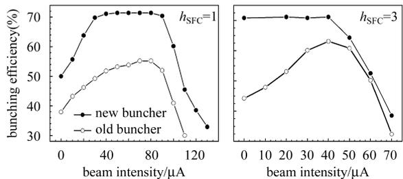
图 4 考虑空间电荷效应的聚束器效率, 0B02 距 SFC 中心平面 4m.
