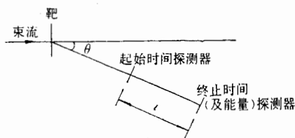
图 1 重离子飞行时间谱仪质量鉴别原理示意图
