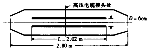
图 1 BEPC 静电分离器的结构示意图
